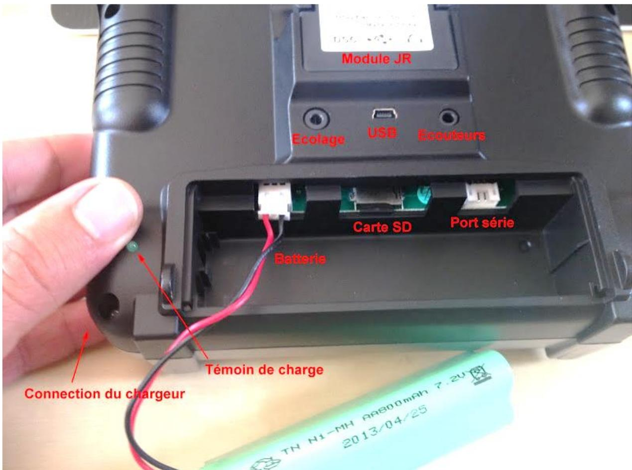
L'arrière de la radio présente un logement pour module compatible JR, une prise d'écolage style JR, un connecteur USB et une prise pour écouteurs. Le compartiment de la batterie contient un connecteur pour carte micro-SD, un port série et bien sûr la connexion de la batterie.
